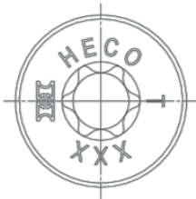
Marquages de tête pour d = 6,0 à 10,0 de types : tête plate fraisée. Type spécifié sans marquage possible également.
